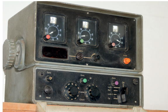
15. Klasyczny odbiornik systemu DECCA; aparaty tego systemu przez pół wieku stanowiły standard w praktyce nawigacyjnej flot, ze zbiorów MNS
